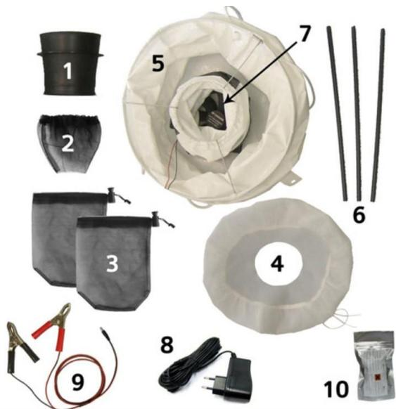
**Figura 6:** trappola BG-Sentinel non assemblata.
