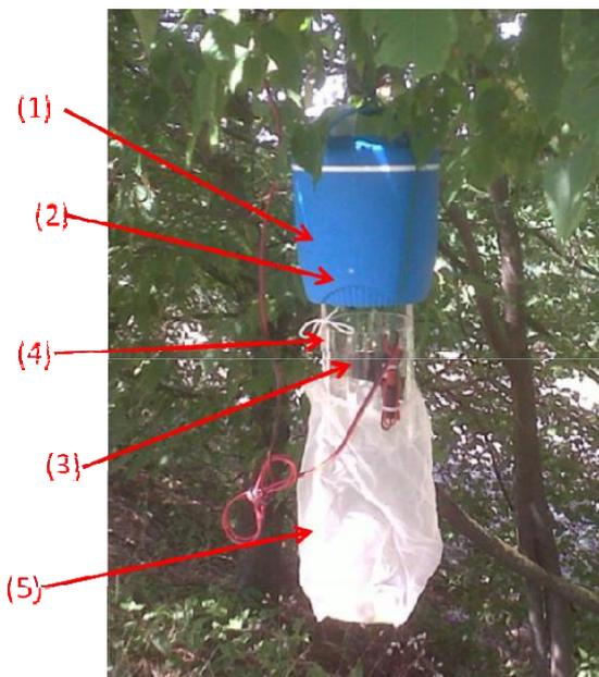
Figura 1: trappola tipo CDC modificata a CO<sub>2</sub>.
