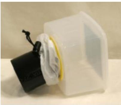
Figura 3: contenitore per la raccolta degli insetti e tubo di aspirazione assemblati.
