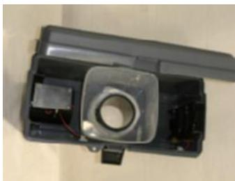
Figura 4: parte superiore della trappola Gravid assemblata.
