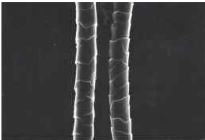
Foto 1. Fibre di lana viste al SEM 1000X (foto: C. Vineis, CNR – ISMAC, Biella, 2015).
