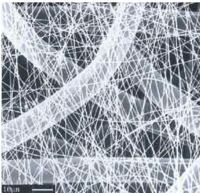
Foto 3. Membrana di nanofibre di cheratina elettrofilate e dettaglio della membrana vista al SEM (foto: Vineis C. et al., 2013).
