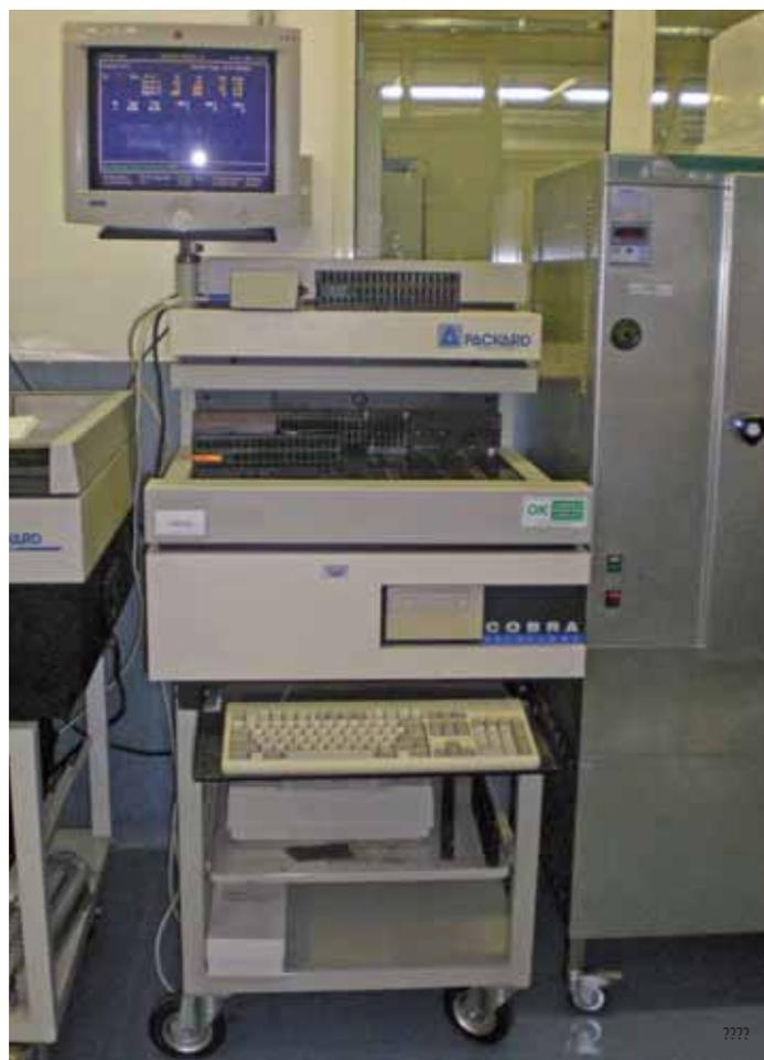
Foto 3. Contatore gamma Packard COBRA mod. 5003.
