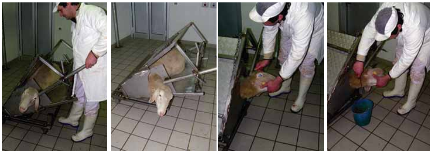
La gabbia non è posizionata al centro del basamento, ma sul lato destro: inclinata appoggia su due prolunghe del basamento.
