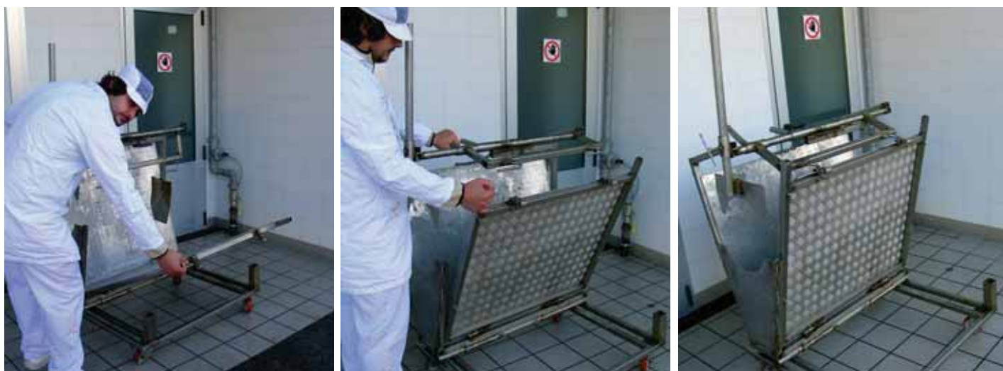
Dopo aver avviato la carcassa dell'ovi-caprino alle altre fasi della macellazione l'operatore solleva la parete sinistra della gabbia bloccandola con il catenaccio posto sulla struttura a ponte. Con un getto d'acqua allontana eventuali feci e schizzi di sangue. La gabbia è pronta per accogliere un alto capo da macellare.
