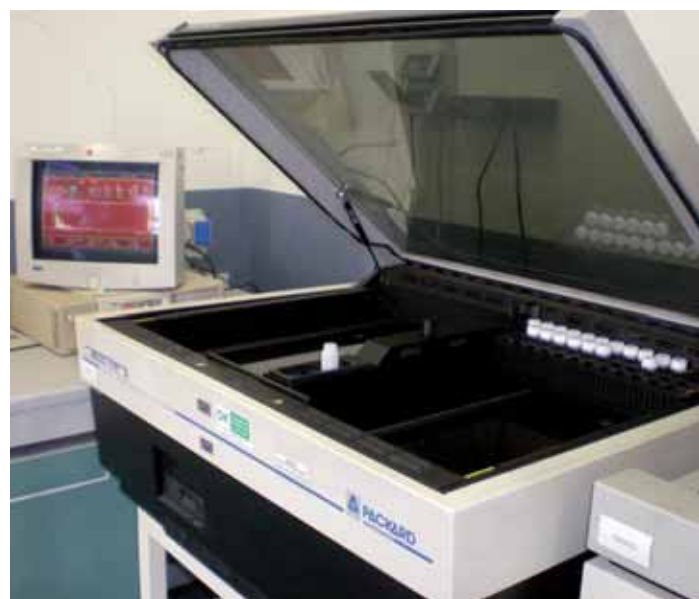
Foto 1. Contatore a scintillazione liquida "Packard Tri-Carb 1900 aggiornato a 2500.
