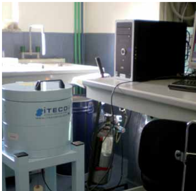
Foto 2. Spettrometro gamma Ortec 905-4 con detector NaI da 3 x 3 pollici.
